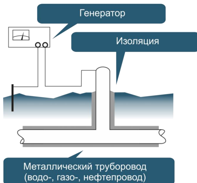
Рис. 2 - Схема подключения индукционного генератора к металлическому трубопроводу
