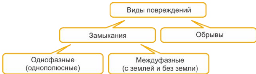
Рис. 1 Виды повреждений кабельных линий
